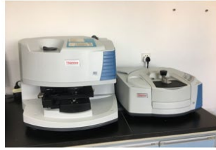
傅立叶变换显微红外光谱仪 (常规红外和纤维红外两部分) 用于鉴定样品成分
