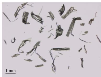
图 6 产生的 PBAT 微塑料照片
