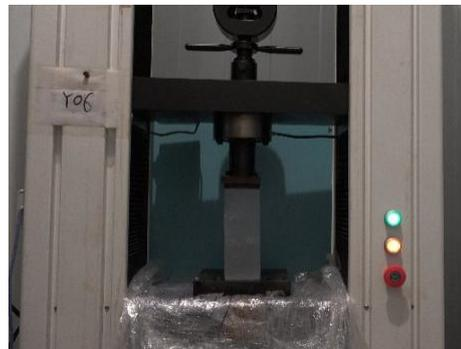
图3 重叠冰试样单轴压缩试验
