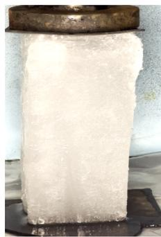
(a) 应变速率为 $10^{-4}$ /s时破坏图
